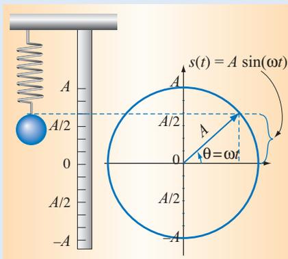
L'idée fondamentale de la modélisation de ce phénomène est de représenter la position par la projection verticale d'un rayon vecteur en rotation à une vitesse constante  $\omega$  en radians par seconde autour de l'origine d'un système d'axes.
